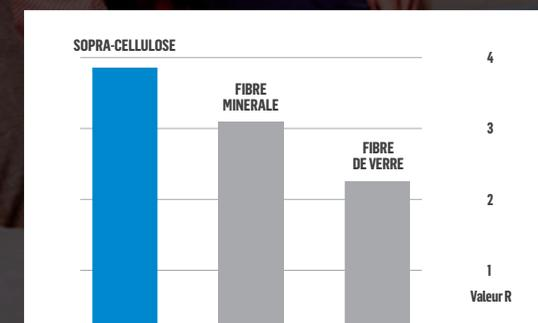
Tableau comparatif de la résistance thermique "R" par pouce d'épaisseur des isolants soufflés les plus courants.
